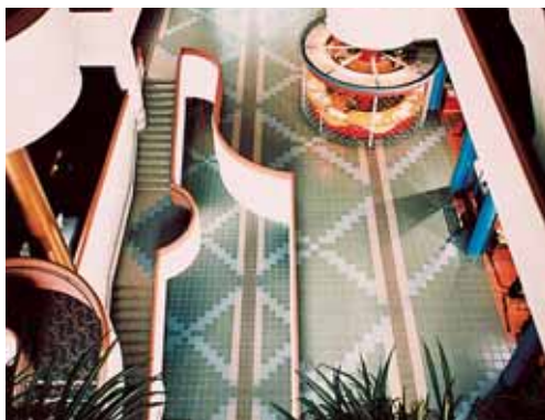
Civic Center - North York Ontario - Kanada Klinkier ułożony na zaprawie Kerabond + Isolastic
